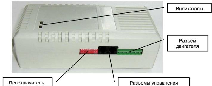
Рисунок 1. Внешний вид блока управления КБЭ.
